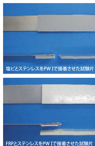
FRPとステンレスをPW Iで接着させた試験片
