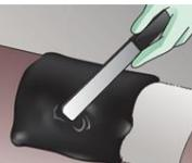
パテナイフやヘラなどで、補修する部分の上、及び周辺に厚めに塗り広げます。冬期など気温が低いと硬化時間が長くなります。投光器や工業用ドライヤーなどで加温することで、硬化を促進させることができます。
