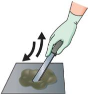
平らな板や厚紙の上に取り出し、パテナイフやヘラなどで混合します。混ぜ残しのないように、均一になるまでしっかりと混合して下さい。冬期など低温下では固くなって混ぜにくくなります。その時は使用前に主剤を温めておくと混ぜやすくなります(目安:20~25℃)。
