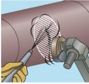
デブコンを塗布する表面は全て乾燥させ、きれいに汚れを落とす必要があります。塗装、錆、メッキなどはショット・ブラスト又は目の粗い研磨工具(ヤスリ、#40サンドペーパーなど)でケレン処理を行います。
