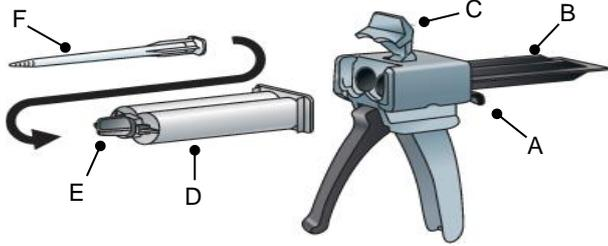
安全掛け具Aを押し上げながら、ロッドBを差し込みます。留め具Cを押し上げ、カートリッジDをセットしたらCを押し下げ固定します。カートリッジのキャップEを外してミックスノズルFをセットします。
