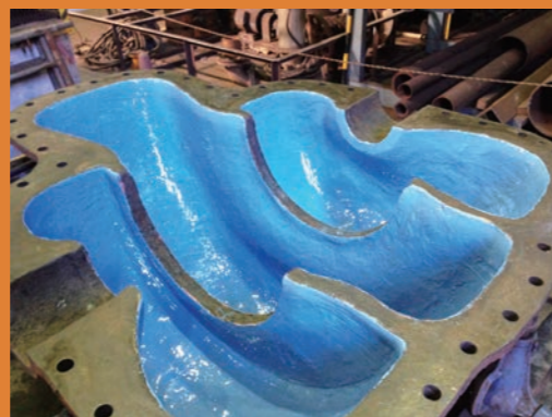
補修 プレミアメタル(左)とブラッシュャブルセラミック(右)で耐蝕補修並びに予防保全。
