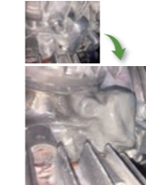
アルミ鋳物の破孔部補修
