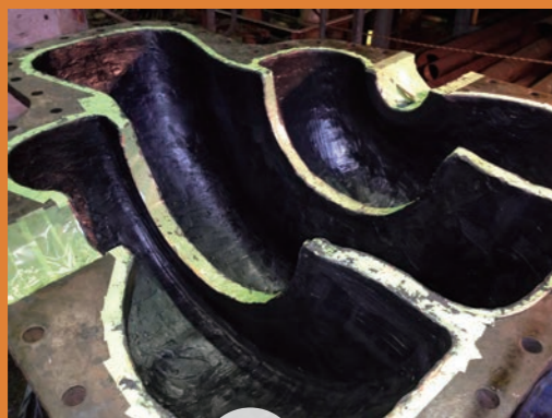
補修 プレミアメタル(左)とブラッシュャブルセラミック(右)で耐蝕補修並びに予防保全。
