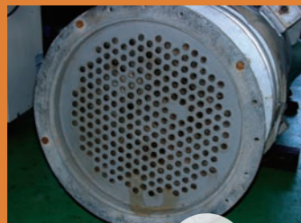
補修 ブラッシュャブルセラミックとセラミックリペアーを使用して、チューブ式熱交換器管板面の恒久的な補修ができる。
