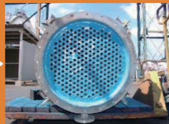
補修 ブラッシュャブルセラミックとセラミックリペアーを使用して、チューブ式熱交換器管板面の恒久的な補修ができる。
